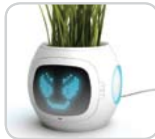
La maceta digital informa del estado de la planta y se programa fácilmente por medio de un cable USB.
